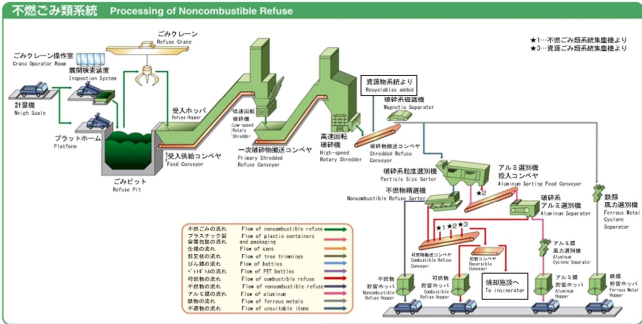
搬入された不燃・粗大ごみは計量された後、プラットフォームからごみピットへ投入され、一度貯留されます。ごみピットからクレーンで受入ホッパに投入されコンベヤで破砕機へ運ばれます。大型で耐久性のあるごみが多く搬入されるため、2種類の破砕機によって段階的に細かく碎かれます。その後、各種選別機(磁力や風力等)により鉄類、アルミ、可燃物、不燃物に選別します。
