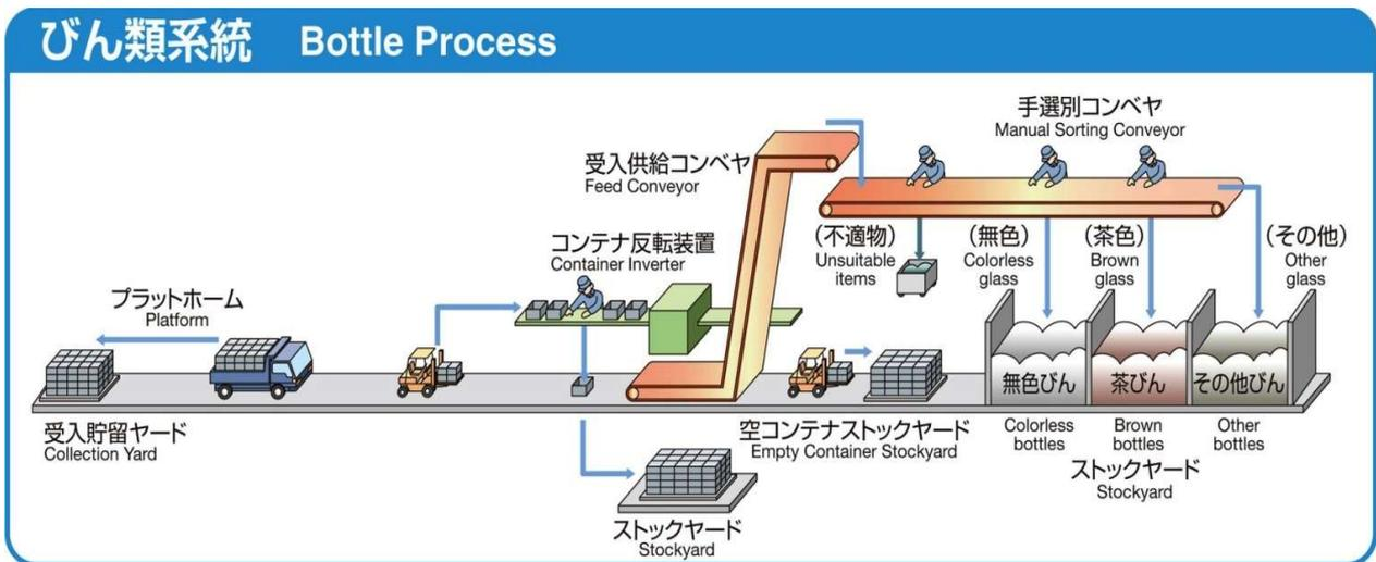
びん類は収集用コンテナに入った状態で搬入されます。コンテナに入った状態ではびんを選別できないため、コンテナ反転装置で中のびんを受入供給コンベヤに落とします。そこから手選別コンベヤに運ばれリサイクルできないものを摘出した後、無色・茶色・その他の色ごとに分けていきます。色ごとに分けたものは、もう一度びんとして再生、または別の製品として再商品化するためにリサイクル工場へ搬出されます。
