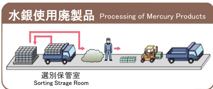
豊中市と伊丹市に設置されている専用回収ボックスで回収された水銀使用廃製品は、クリーンランドに搬入されます。搬入された水銀廃製品のうち、蛍光灯は形状ごとに専用の保管ケースにて保管し、乾電池等はドラム缶にて保管します。その後、一定の量が溜まると適正処理が可能なリサイクル工場へ運ばれます。
