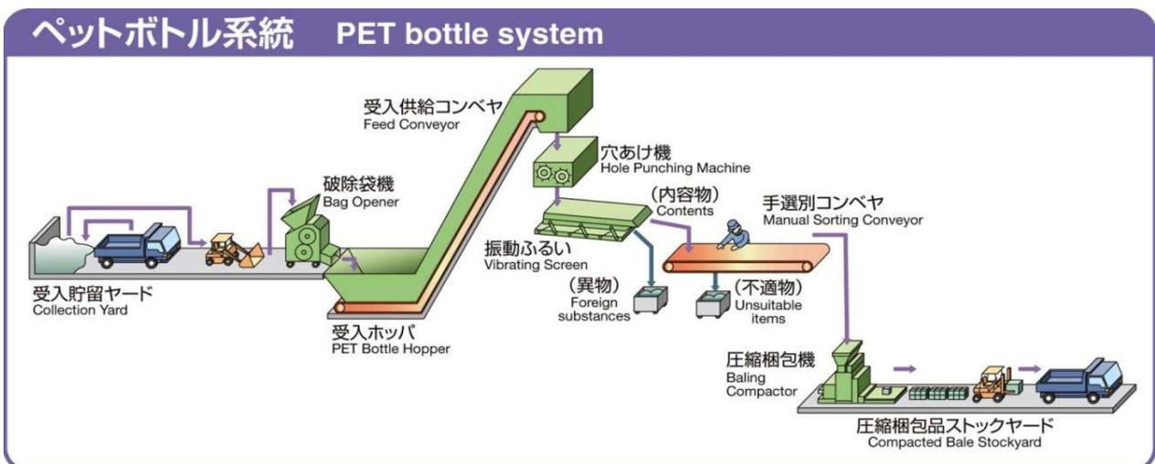
集められたペットボトルは、受入貯留ヤードに搬入され処理を行うまでの間、溜められます。ごみ袋は異物になってしまうため、破除袋機でごみ袋を取り除き、受入ホッパに投入します。この時点では中身の入ったものや異物が混入している状態なので、コンベヤで穴あけ機、振動ふるいに運ばれ、それらを取り除きます。
