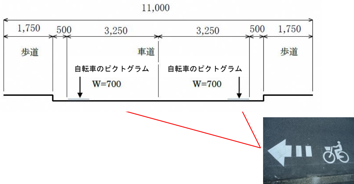
図 3 断面図（自転車のピクトグラムの設置）
