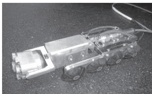
写真4-15 テレビカメラによる詳細調査
