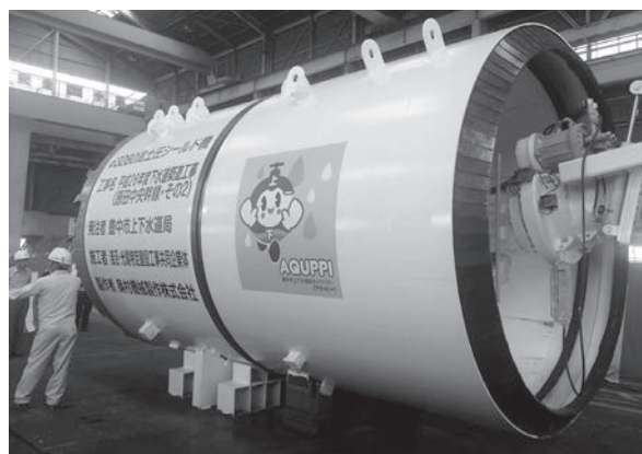
写真4-5 シールドマシン（掘削機）
