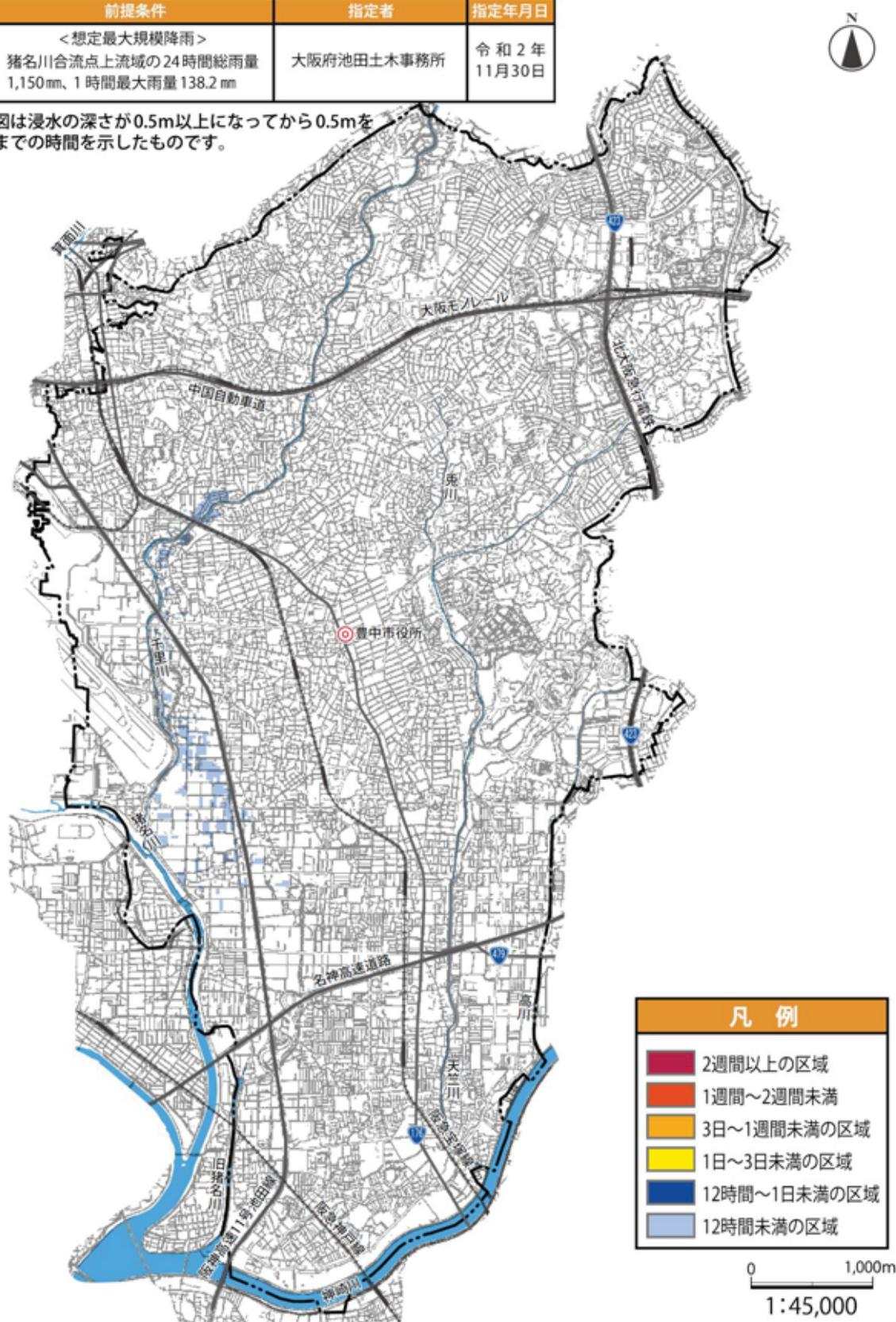
図1-19 浸水想定区域図 浸水継続時間(千里川)
