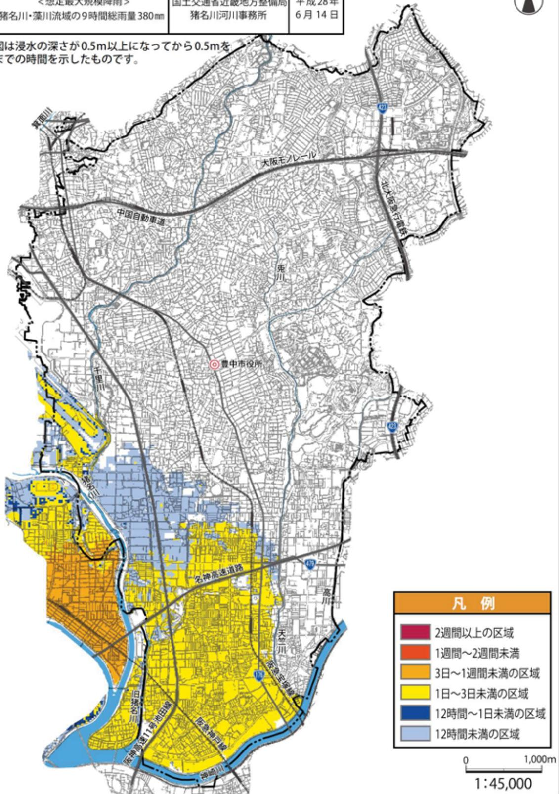
図1-15 浸水想定区域図 浸水継続時間 (猪名川)
