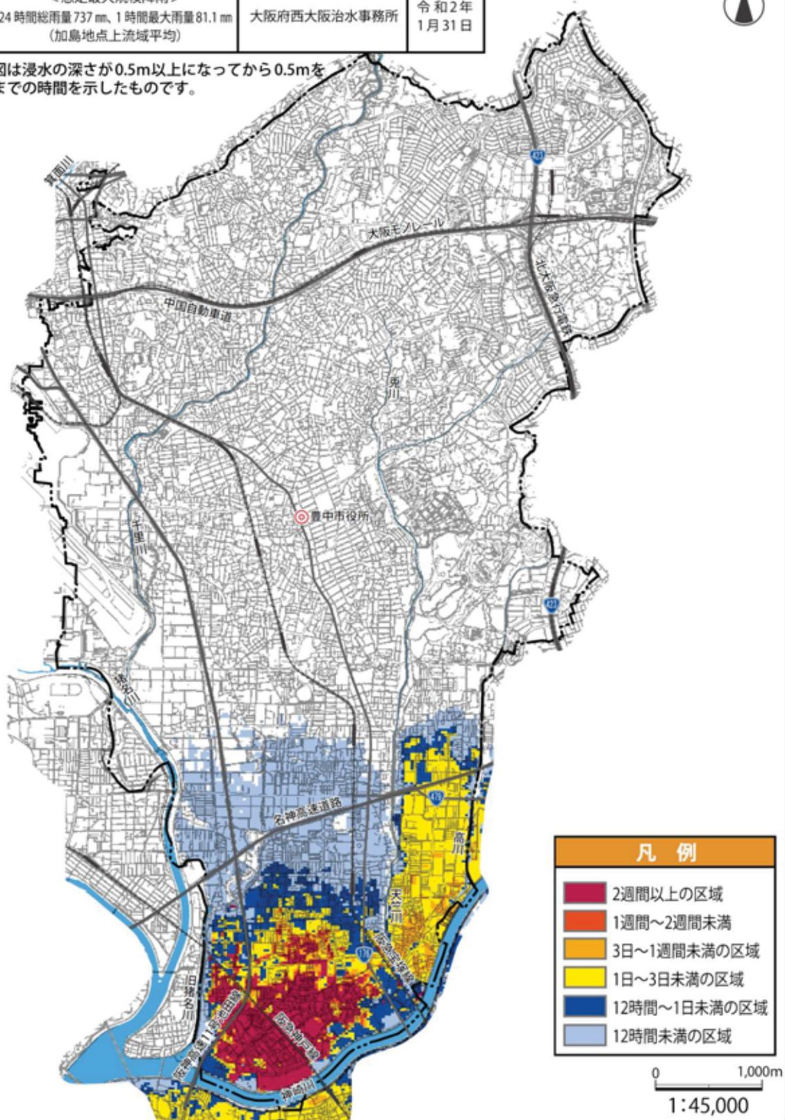
図1-17 浸水想定区域図 浸水継続時間 (神崎川)
