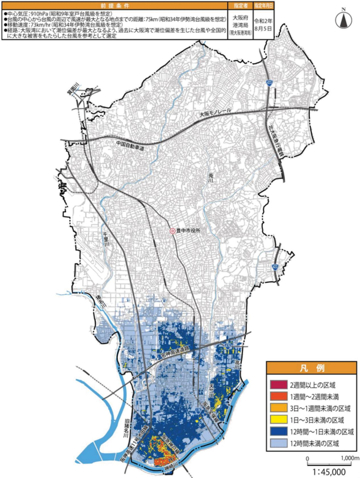
図1-25 高潮浸水想定区域図 浸水継続時間
