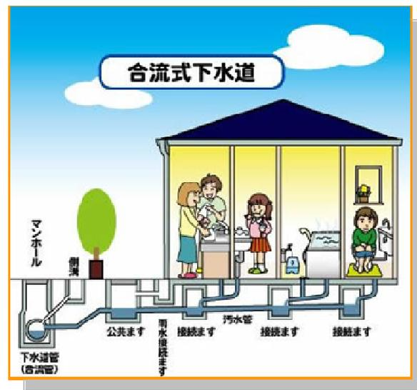
本市は、市内の約40%が「合流式下水道」となっています。「合流式下水道」では、合流管に雨水が一定量以上流れ込むと、下水を下水処理場で処理しきれなくなります。そのため、処理できない下水の一部を河川に流すため、河川の水質が悪化するという問題があります。その対策として上下水道局では、「貯留管や滞水池の設置」や「雨水吐室の改良」を進めています。
