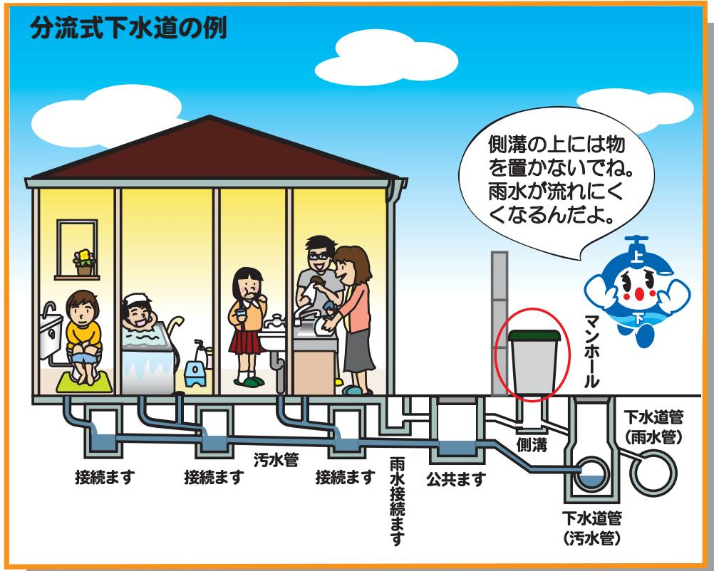
※汚水、雨水の両方を合流管と一緒に集めて流す「合流式下水道」もあります。
