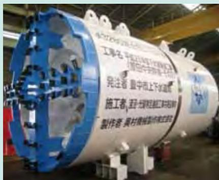
シールドマシンという掘削機を、基地である萩の寺公園の地下11メートルのところに搬入し、設置します。
