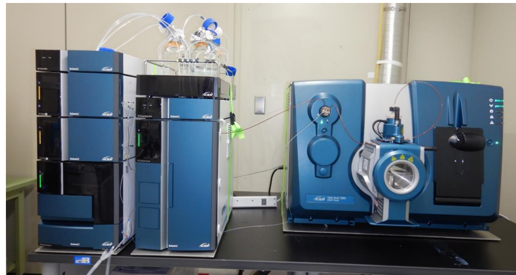
高速液体クロマトグラフ質量分析計 PFOS・PFOAの分析に使用
