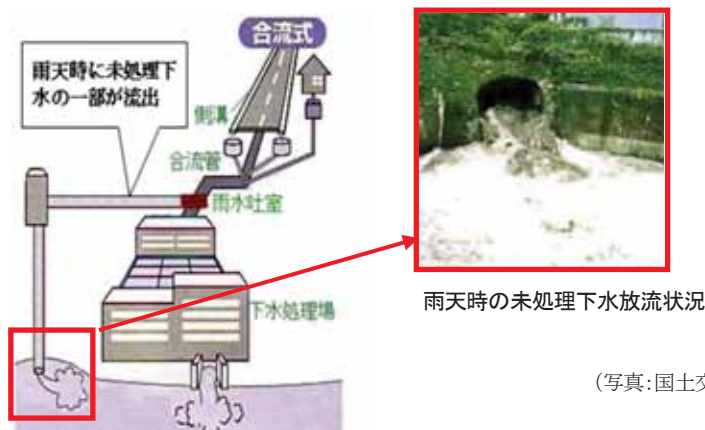
合流式下水道から未処理下水を公共用水域へ流出(イメージ)
