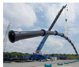
耐震管※のデモンストレーション
