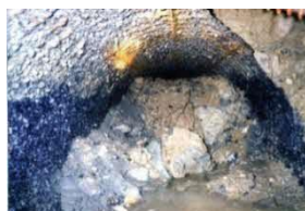
硫化水素※による下水道管の腐食
