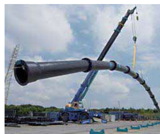
耐震管※のデモンストレーション
