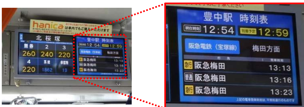
図 2.50 バス車内での駅到着予定時刻や乗継可能な鉄道発車時刻の案内の状況
