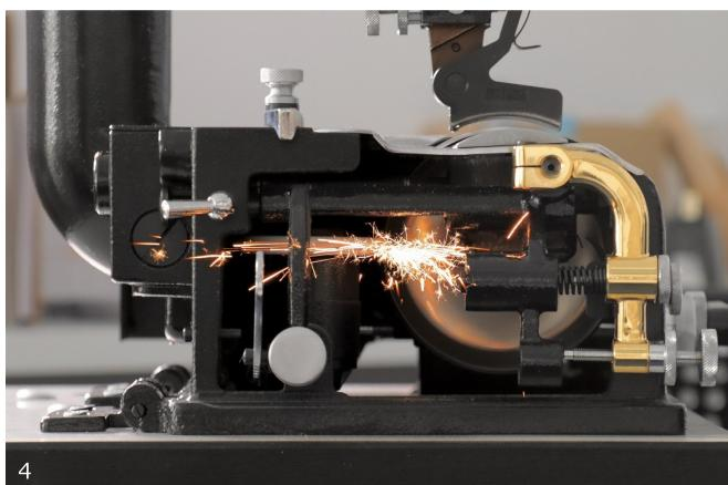
写真4は刃研ぎの様子になります。電動革漉き機の製品によっては定期的な刃の交換を必要としますが「TK-802BL」には研ぎ石が内蔵されています。刃研ぎがおこなえることで、刃の交換は半永久的に必要がなく、ランニングコストも抑えることができます。
