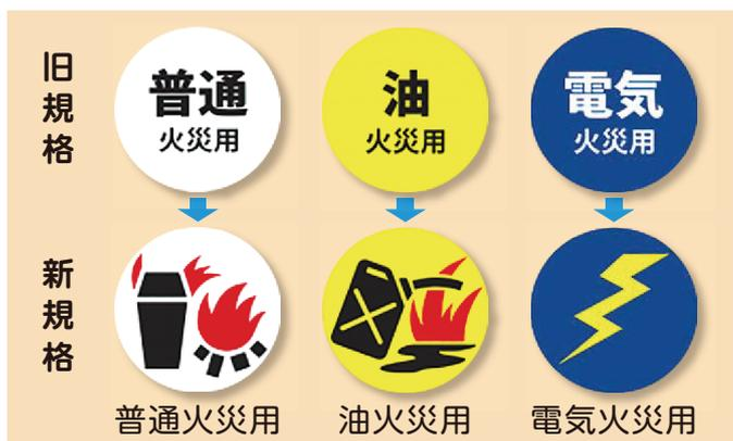
適応火災のマークが旧規格の消火器は、2021年12月31日までに、新規格消火器への交換が必要です。
