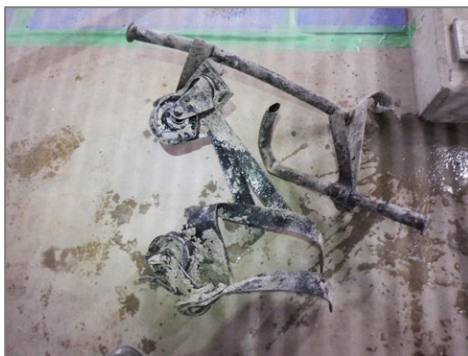
焼却できずにコンベヤで詰まり、職員が手作業で取り出した金属
