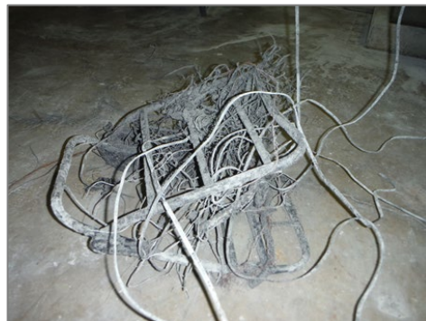
焼却できずにコンベヤで詰まり、職員が手作業で取り出した金属
