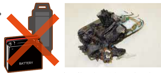
処理施設内で発火した充電式電池
