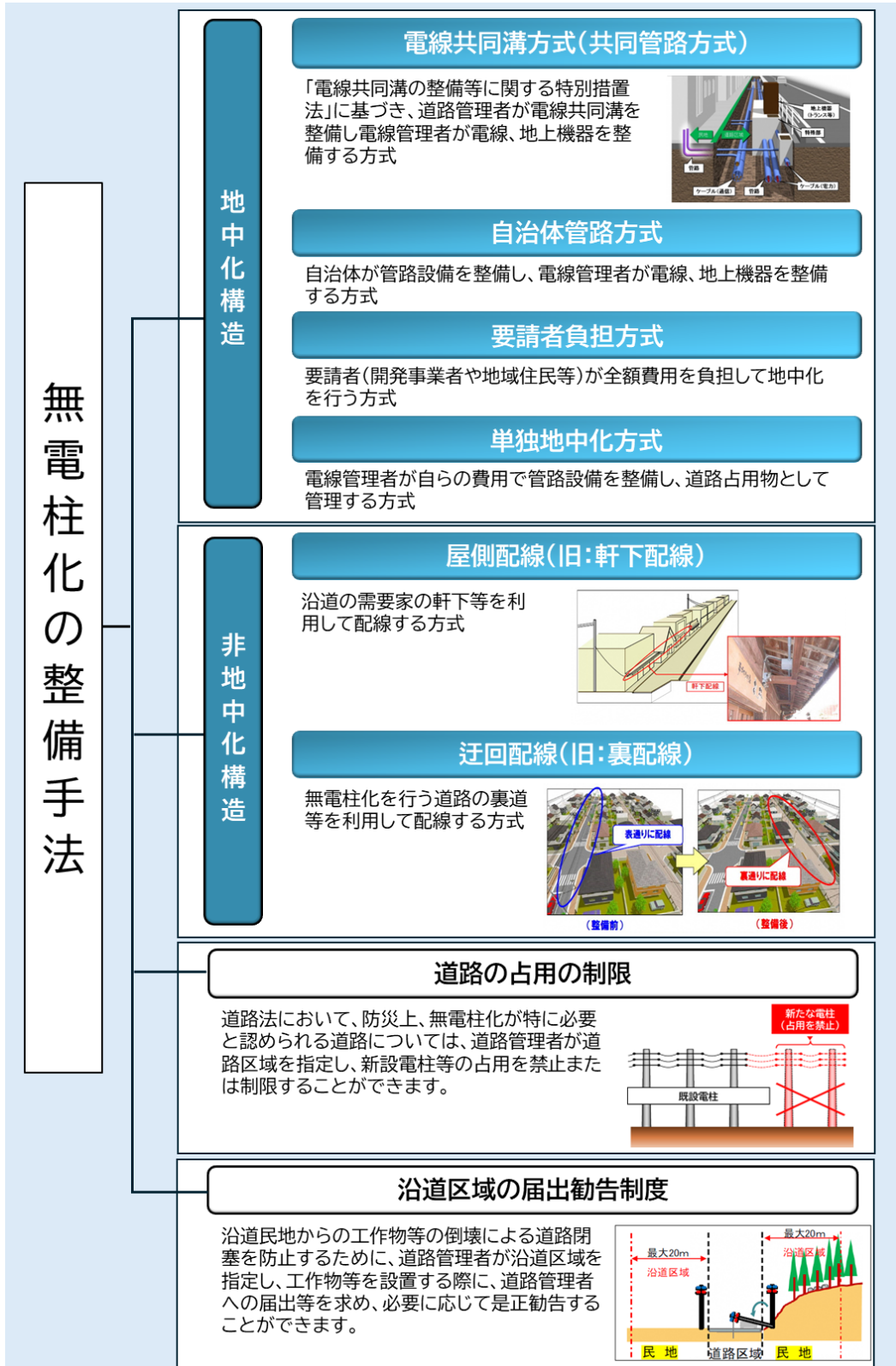
図1-3 無電柱化の整備手法
