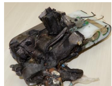
処理施設内で発火した充電式電池
