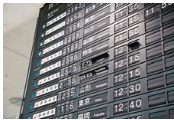
北ターミナルJAL(日本航空)側の保安検査場入口の反転フラップ式案内表示機。開発した会社の名前から「ソラリー式」、表示がパタパタと音を立てて変わることから「パタパタ式」とも呼ばれます。近年はデジタル式への移行が進んでいるため、貴重な存在となっています。
