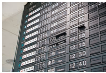
北ターミナルJAL(日本航空)側の保安検査場入口の反転フラップ式案内表示機。開発した会社の名前から「ソラー式」、表示がバタバタと音を立てて変わることから「バタバタ式」とも呼ばれます。近年はデジタル式への移行が進んでいるため、貴重な存在となっています。
