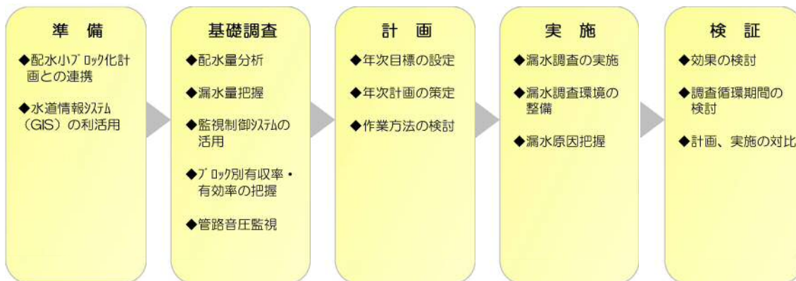
図-1.2 漏水防止対策施行の手順
