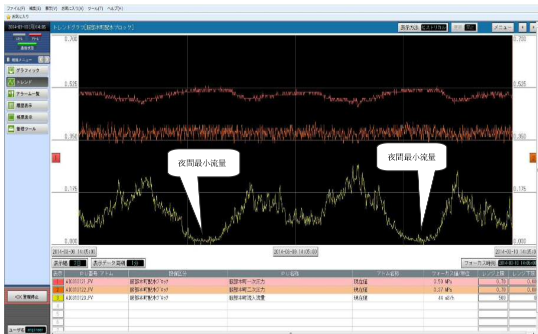
図-3.5 監視制御システムのトレンドグラフ表示
