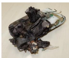
処理施設で発火した充電式電池
