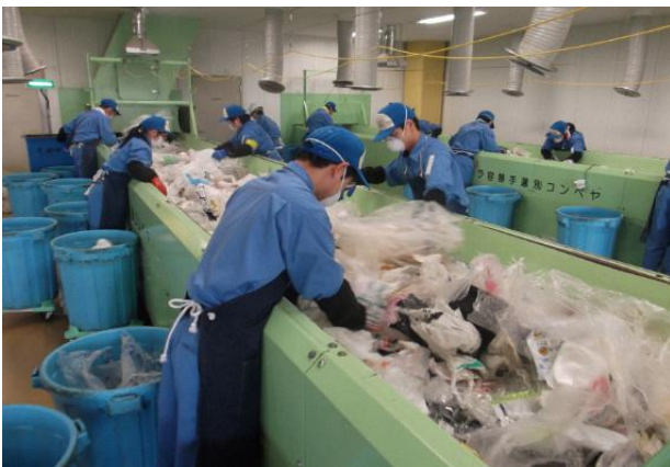
▲プラスチック製容器包装の手選別ライン
