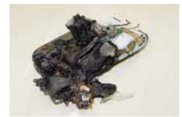
処理施設内で発火した充電式電池
