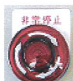
非常停止ボタン
