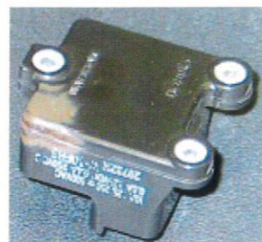
④リミットスイッチが雷などで焼損していないか
