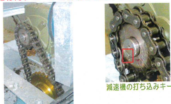
中央部の走行用チェーンと駆動用の歯車（スプロケット）
