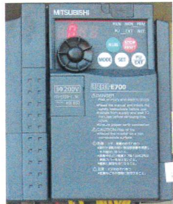
【走行用インバーター】と書かれたこのような部品が、制御盤内にあります
